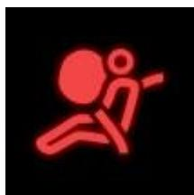
Ukoliko se ova lampica aktivira ili treperi, postoji greška u sistemu zračnih jastuka. Savjetujemo da vozilo odvezete na servis da otklonite grešku. Ukoliko se greška ne otkloni, postoji mogućnost da se zračni jastuci i sigurnosni pojasevi ne aktiviraju u slučaju saobraćajne nezgode.
