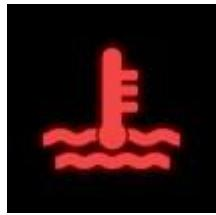
Ukoliko vam se ovaj svjetlosni signal aktivira, preporučujemo da stanete gdje je bezbjedno i odmah isključite motor. Provjerite da li je nivo rashladne tekućine ispravan (da li imate dovoljno rashladne tekućine u sistemu) i po potrebi je dospite.
