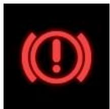
Crveni svjetlosni signal normalno ukazuje na to da je parkirna (ručna) kočnica aktivirana. Ukoliko je lampica „upaljena“, a parkirna kočnica nije aktivna, onda provjerite da li u vozilu nedostaje ulje za kočnice. Ukoliko je ovaj svjetlosni signal aktivovan i nakon dolivanja ulja, preporučujemo da kontaktirate servis i popravite kvar.
