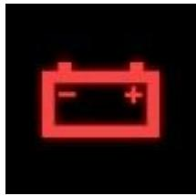
Ovaj svjetlosni signal označava grešku u električnom sistemu. Ova lampica najčešće ukazuje na to da se akumulator ne puni ili da postoji kvar na alternatoru. Ukoliko je ovaj svjetlosni signal aktiviran i nakon startovanja motora, savjetujemo da u što kraćem roku odvezete vozilo na servis, iz razloga što može doći do toga da se akumulator isprazni u potpunosti i ošteti.
