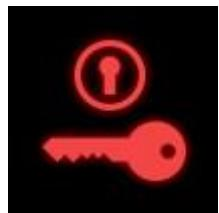
Ukoliko je ovaj svjetlosni signal crven i motor radi, ne isključujte ga jer je moguće da nećete moći ponovo da ga aktivirate. Savjetujemo da odvezete vozilo na servis radi otklanjanja problema. Ukoliko je ovaj svjetlosni signal žut, postoji greška u sistemu. Savjetujemo da posjetite servis, da bi se mogla ustanoviti greška.
