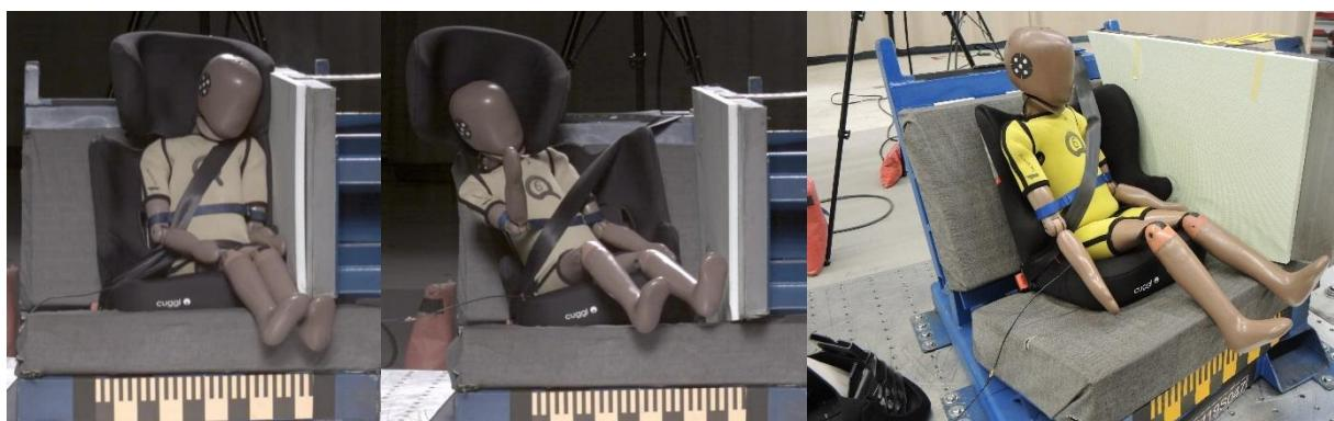
Slika 2: Nania Racer SP tokom testa bočnog udara
