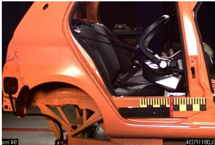
*Slika 1. Test sudara s nepravilno postavljenom nosiljkom za novorođenčad (pojas za krilo i rame su pomiješani)*
