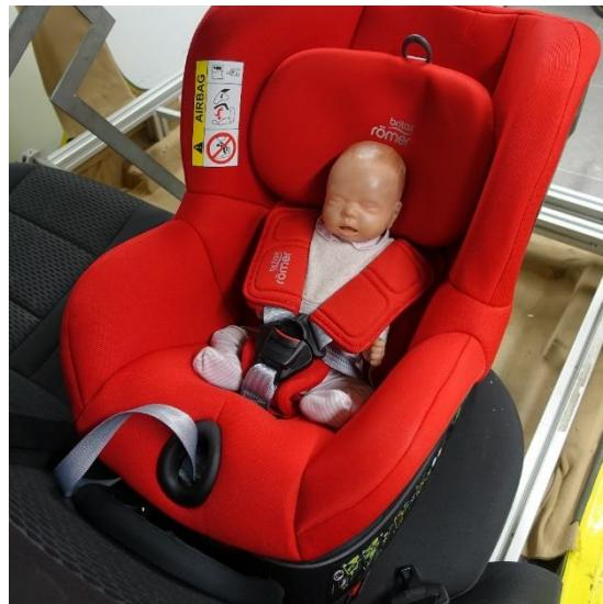
*Slika 3. Mjerna lutka za novorođenče u Britax Römer Dualfix 2 R autosjedalici*
