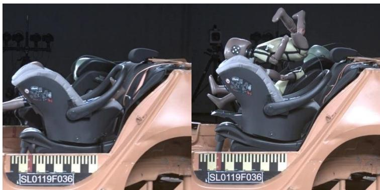
**Slika 5. Chicco Oasys i-Size Bebecare + i-Size Base prilikom frontalnog udara sa Q1 lutkom**
