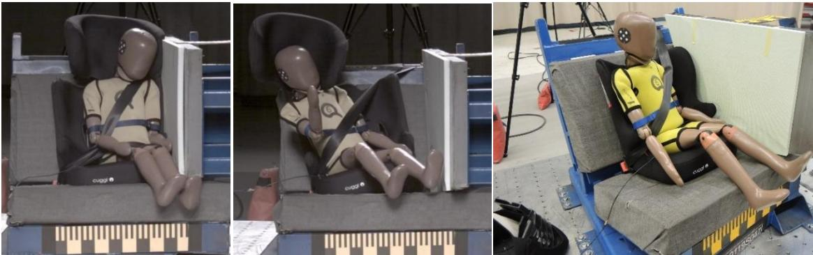
*Slika 7. Chaffinch tokom testa i nakon testa bočnog udara*
