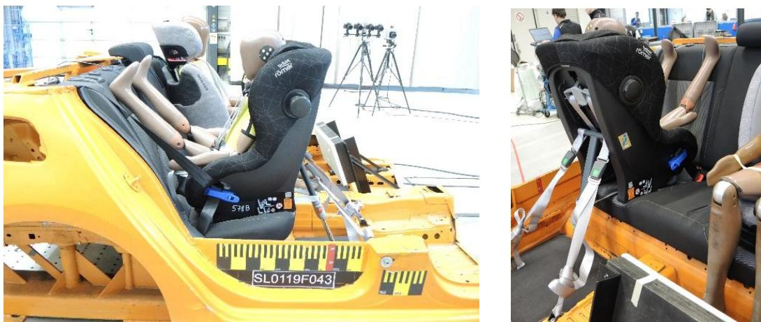
*Slika 10. Britax Römer Max-Way Plus postavljen prilikom ispitivanja*
