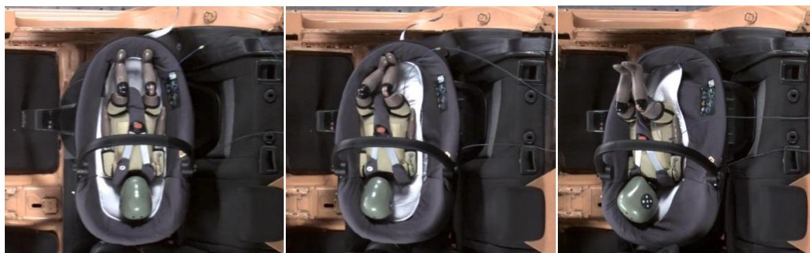
*Slika 3. Bébé Confort Jade u ispitivanju frontalnog udara pomoću lutke Q1*
