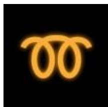
Normalno je da je ovaj svjetlosni signal aktivan par sekundi nakon davanja kontakta. Ovaj svjetlosni signal označava da rade grijajući dizel goriva. Ukoliko je lampica aktivna ili treperi dok motor radi, postoji greška u sistemu upravljanja motorom. Savjetujemo da odvezete vozilo do servisa radi otklanjanja greške.
