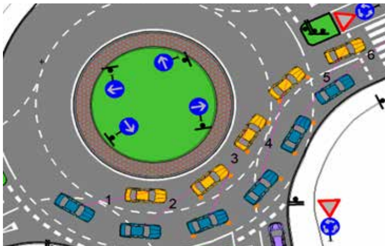
Slika 14. Primjer isključenja iz dvotračnog kružnog toka saobraćaja
