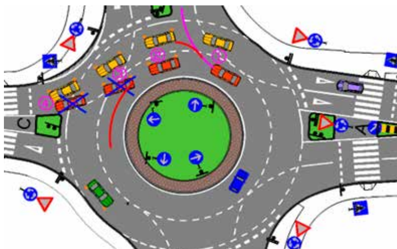
Slika 16. Zakašnjelo prestrojavanje na jednom izlazu iz dvotračnog kružnog toka
