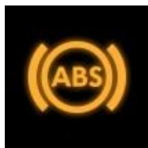
Ukoliko je ovaj svjetlosni signal aktivran, sistem protiv blokiranja točkova prilikom kočenja je neispravan. Automobil i dalje može kočiti, ali savjetujemo da pažljivo vozite/kočite, iz razloga što ABS i ESP (sistemi kontrole stabilnosti) nisu aktivni. Savjetujemo da kontaktirate servis radi otklanjanja kvara.
