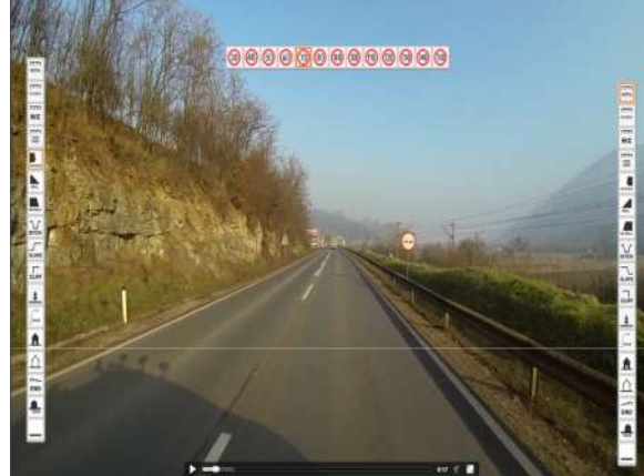
Primjer rizične lokacije sa opasnom površinom stijene sa vozačeve strane ceste
