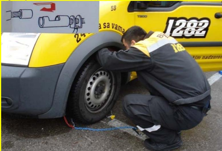
5. Prednji bočni lanac zatvorite u krug zelenom kukom (u našem slučaju), te namjestite obruč tako da ne leži na vrhu točka.
