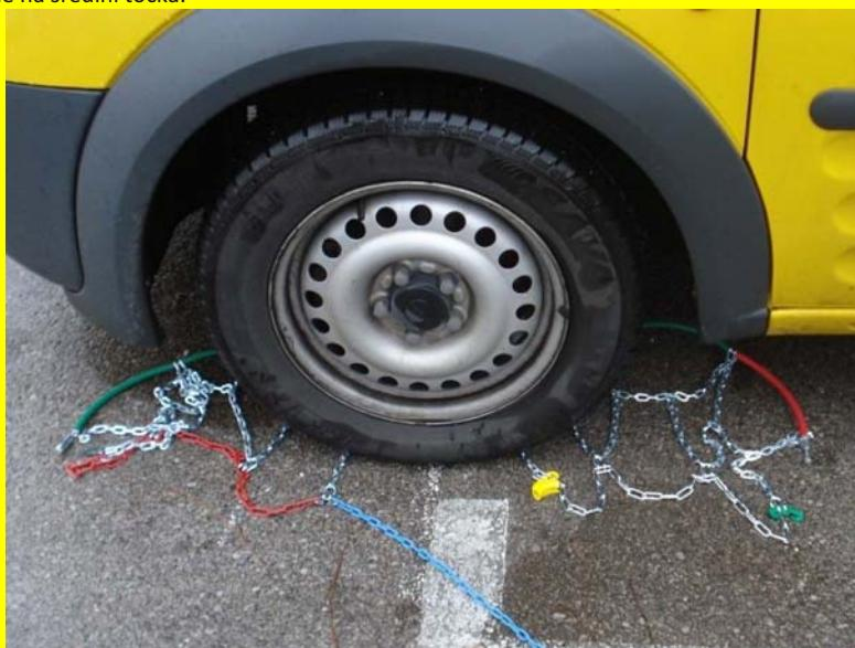
4. Podignite lijevu i desnu stranu obruča, te ih na vrhu točka spojite
