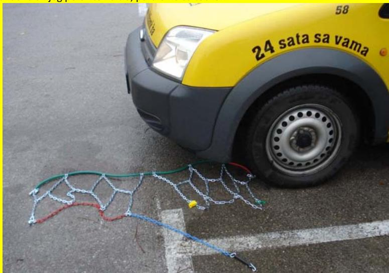
3. Lanac za snijeg provucite sa unutrašnje strane točka, tako da sredina gumenog obruča bude na sredini točka.
