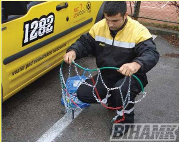
2. Lanac za snijeg položite na tlo, paralelno sa točkom
